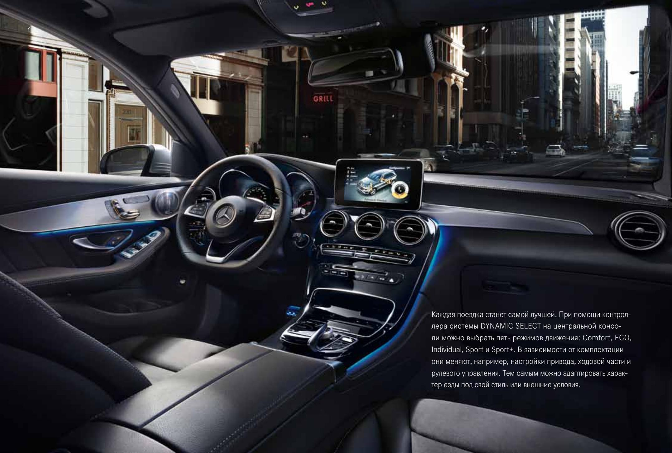
Каждая поездка станет самой лучшей. При помощи контроллера системы DYNAMIC SELECT на центральной консоли можно выбрать пять режимов движения: Comfort, ECO, Individual, Sport и Sport+. В зависимости от комплектации они меняют, например, настройки привода, ходовой части и рулевого управления. Тем самым можно адаптировать характер езды под свой стиль или внешние условия.
